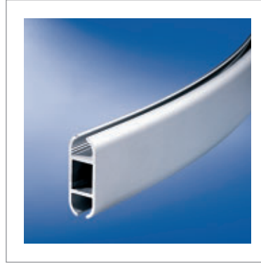
Aluminium-Schiene 17 x 44 mm, silber eloxiert, passend für Keder D = 8,5 - 10 mm
