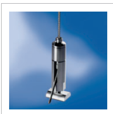
Schienengleiter Messing vernickelt, mit integriertem Seilspanner, für Aluminium-Schiene, 17 x 44 mm und Aluminium-Rundprofil D = 30 mm, passend für Stahlseil 1,5 mm, D = 11 mm, L = 48 mm
