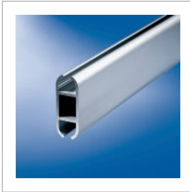
Aluminium-Schiene 17 x 44 mm, silber eloxiert, passend für Keder D = 8,5 - 10 mm
